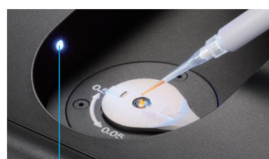
LEDアシストライトにより 溶液の滴下をサポート
